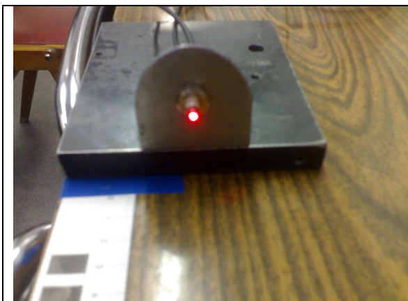
Fig. 5.7 Pozitionarea fibrei senzului in vederea colectarii distantelor corespunzatoare axei Y
